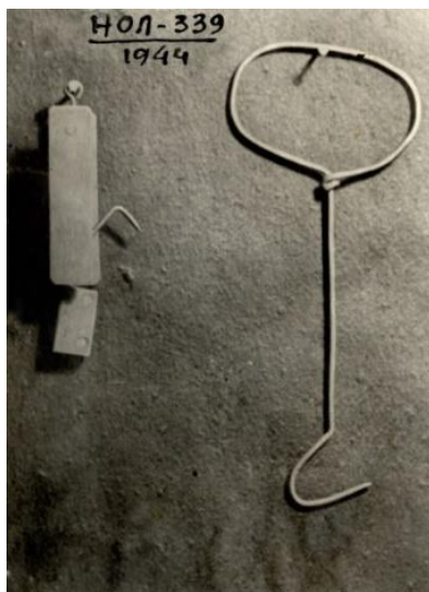
Рис. 7. Крючок для выемки оксипатронов из термосов. 1944 г.
